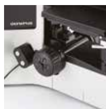
Поворот ручного переключателя механической головки
