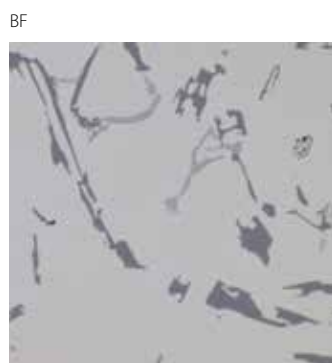
Шлифованный образец AISi
